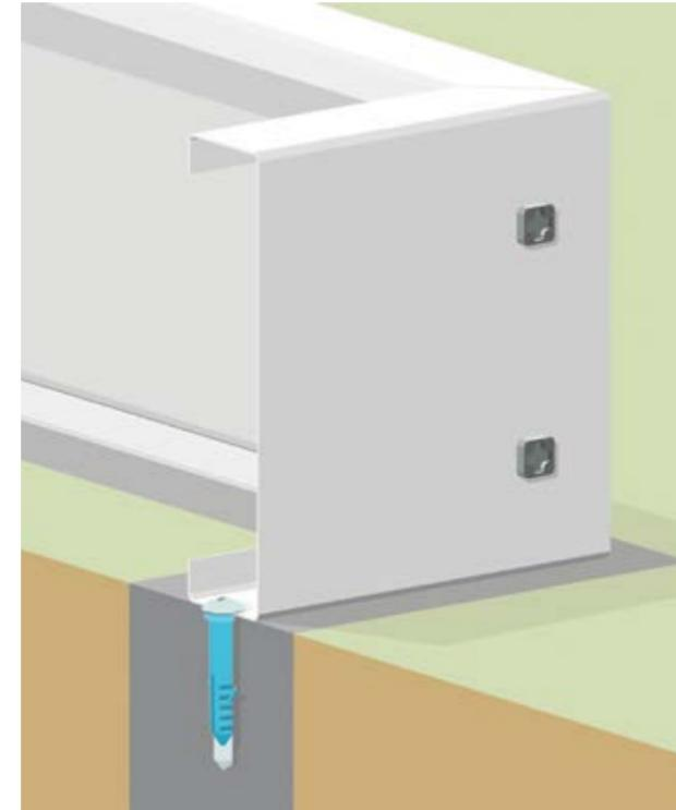
Bei dieser Art der Fundamentierung heben Sie gemäß dem Sockelmaß einen ausreichend breiten Graben (s. Montageanleitung) aus, 60 bis 80 cm tief, sodass das Fundament frostfrei gründet. Füllen Sie ca. 20 cm Frostschutzkies ein und verdichten Sie ihn. Der Kiesgrund kann um weitere Lagen erhöht werden, mindestens 30 cm Höhe sollten für den Beton bleiben.
