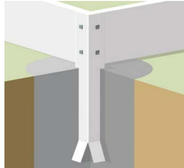
Das Punktfundament sollten Sie ausschließlich in Verbindung mit einem Stahlblechfundamentrahmen nutzen.
